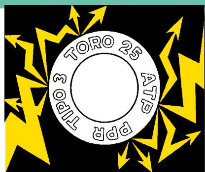
Come ogni materiale plastico il PPR è un cattivo conduttore elettrico con elevate caratteristiche isolanti, e ciò dà sicure garanzie contro il fenomeno di corrosione determinato da correnti vaganti.
