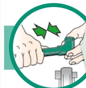
Assemblare le parti l'una nell'altra, senza ruotare e nel tempo ammissibile (tabella DV5 2207).
