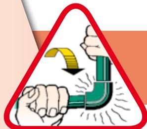
Percurvature inferiori a otto volte il diametro NON usare la fiamma ma aria calda soffiata.
